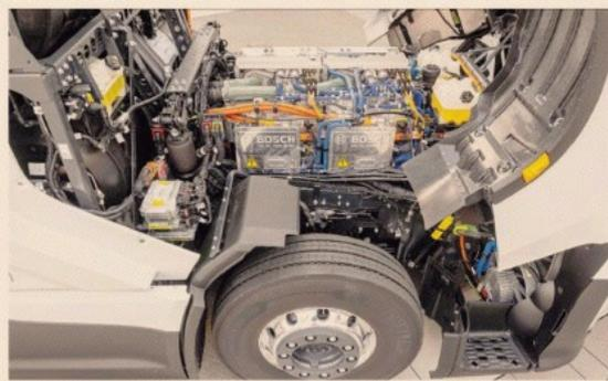
Fuel cell. Il primo camion elettrico a celle di idrogeno prodotto a Stoccarda da Bosch sarà sulla strada nel prossimo autunno
